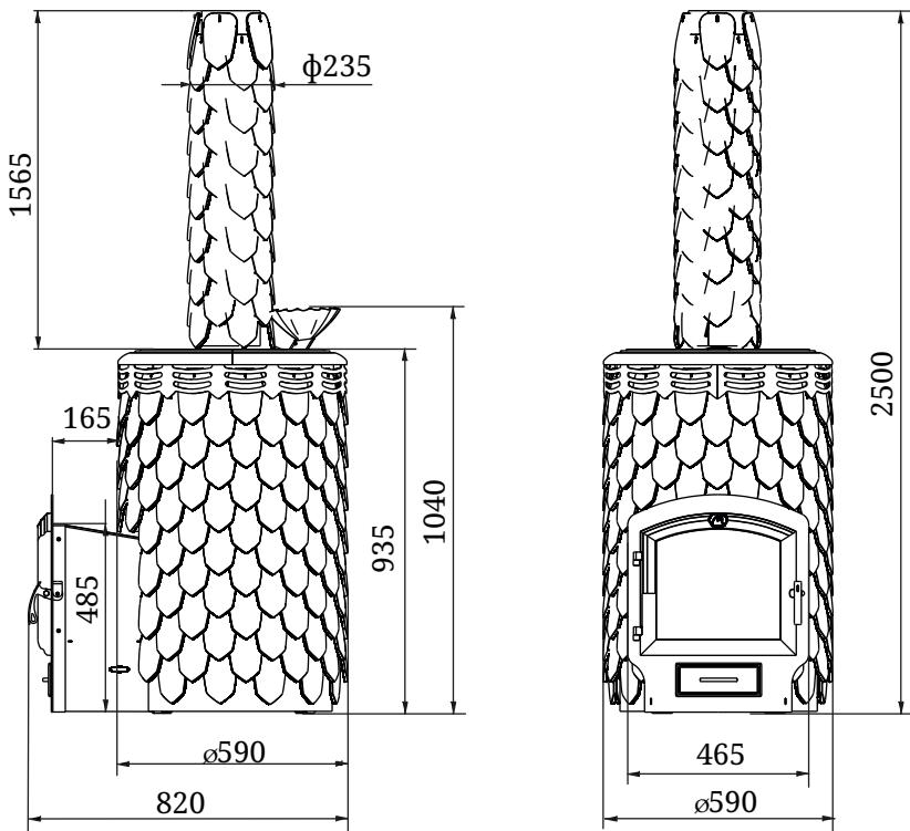
Рисунок 1. Габаритно-монтажные размеры печи «Альфа Пангулина»
